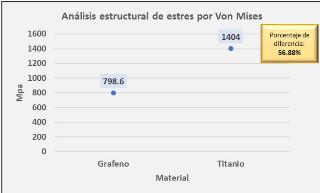
Figura 4.12.1 Gráfica de máximos y mínimos del análisis de estrés mecánico por el método de Von Mises [Imagen propia].
