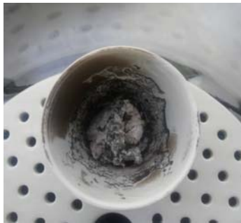
Figura 34. Ejemplo de crisol con residuo incinerado.
