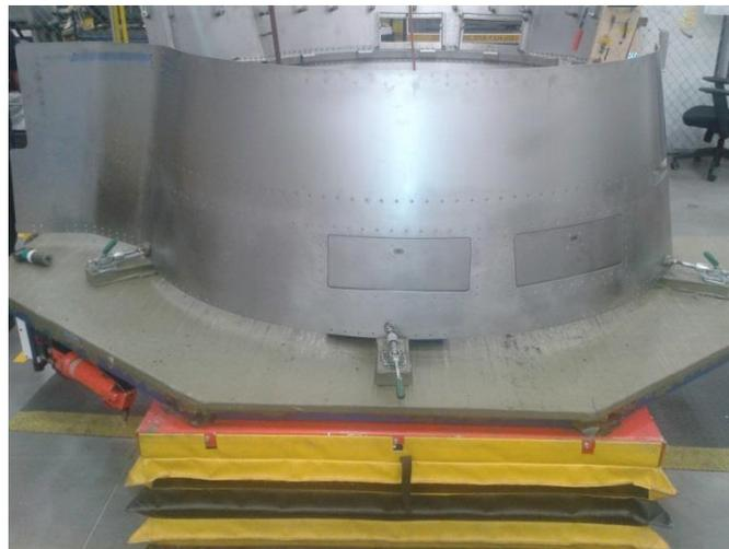
Figura 2 Core Cowl 787 sobre plataforma de altura ajustable (Fotografía)
