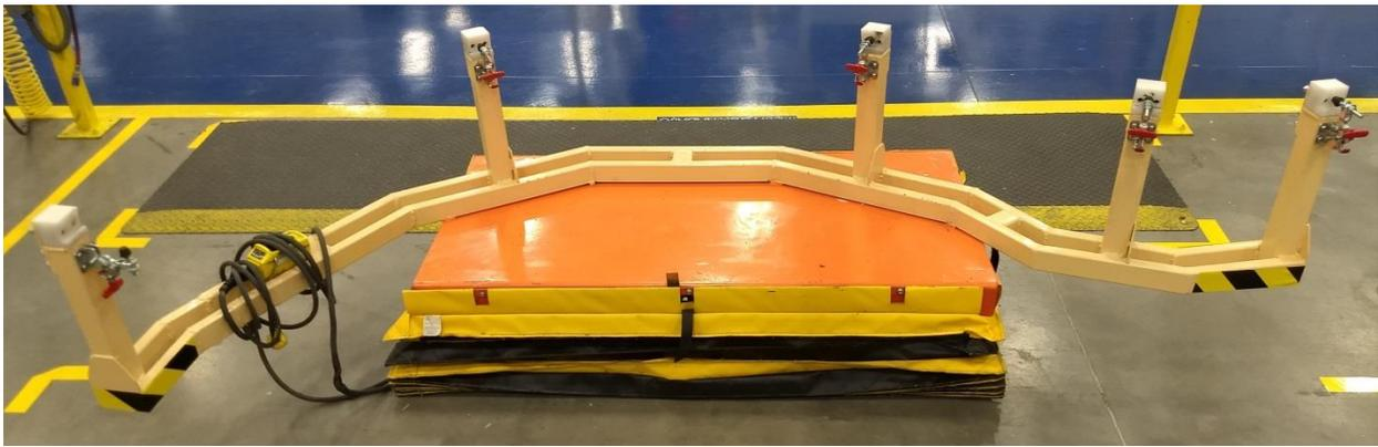
Figura 21 Prototipo de Estructura de Sujeción para Core Cowl
