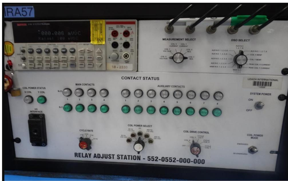
**Figura 10. Equipo de prueba. Estación de ajuste de relevador.**
