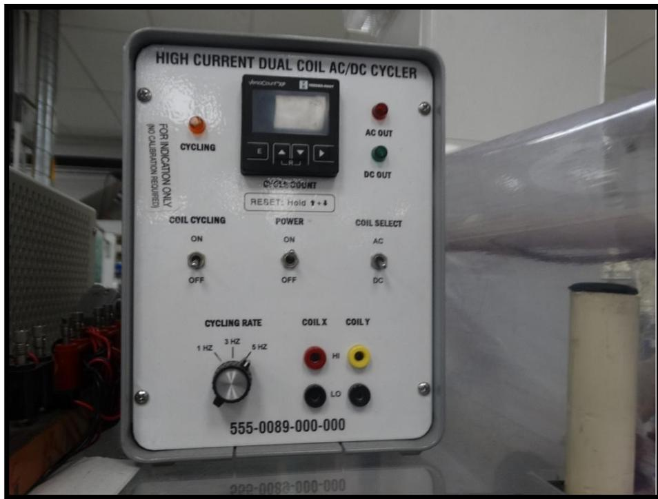
Figura 13. Equipo de prueba. Estación de ciclado de relevador.
