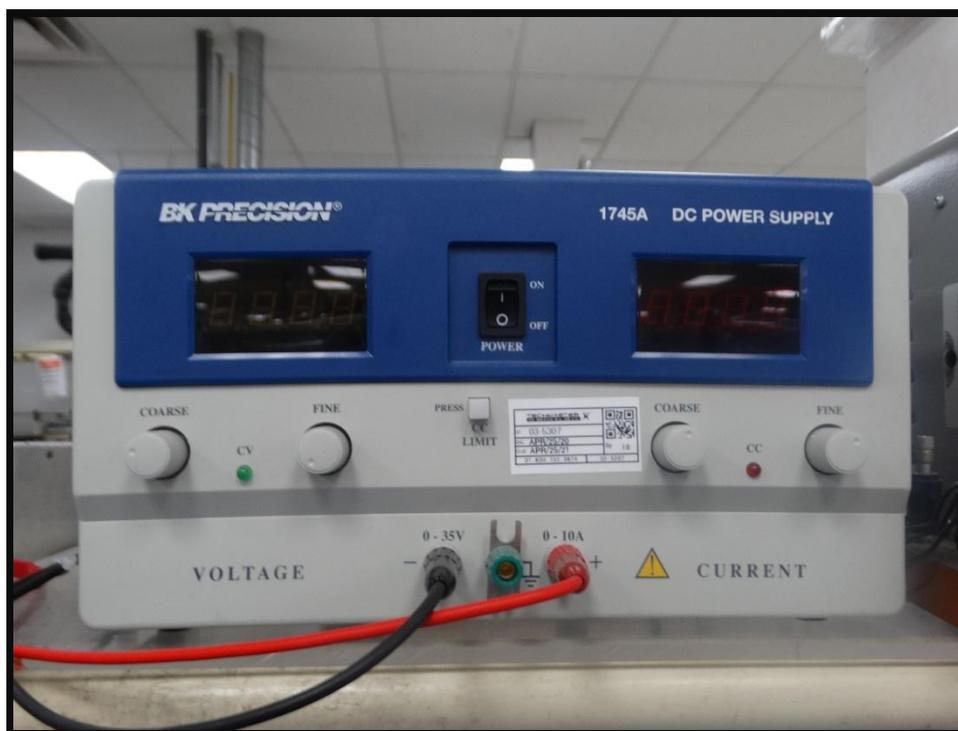
**Figura 12. Equipo de prueba. Estación de caída de voltaje en contactos.**
