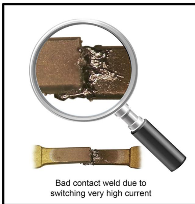
**Figura 2. Muestra grafica de un contacto dañado por funcionamiento de relé sobre temperaturas fuera de especificación.**
