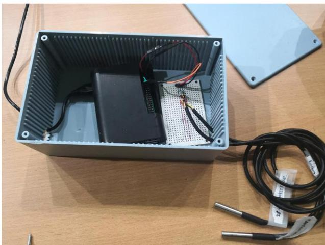
Fig. 4. Raspberry pi3 con sensores DS18B20
