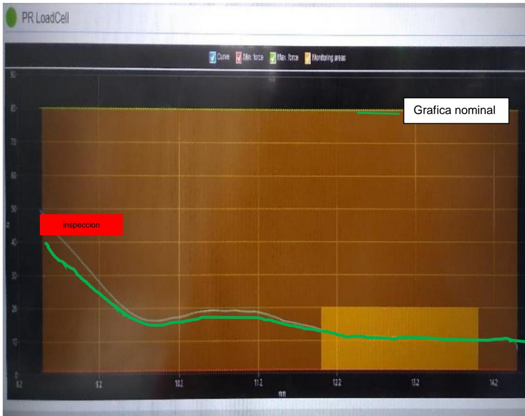
Fig. 37 Grafica obtenida cuando se ensamble demasiado
