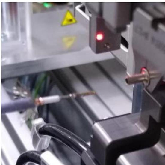
Figura 11. Proceso de inserción automático
