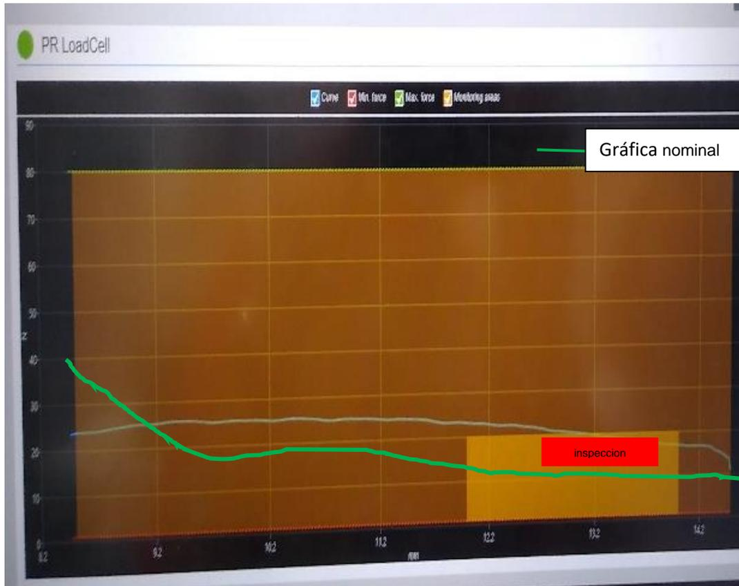
Fig. 36 Grafica obtenida cuando se ensambla fuera de posición
