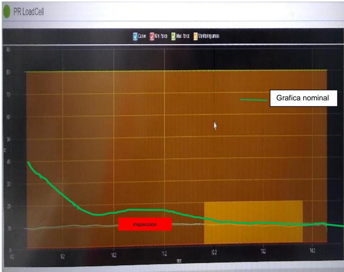
Fig. 35 Grafica obtenida cuando se ensamble sin terminal
