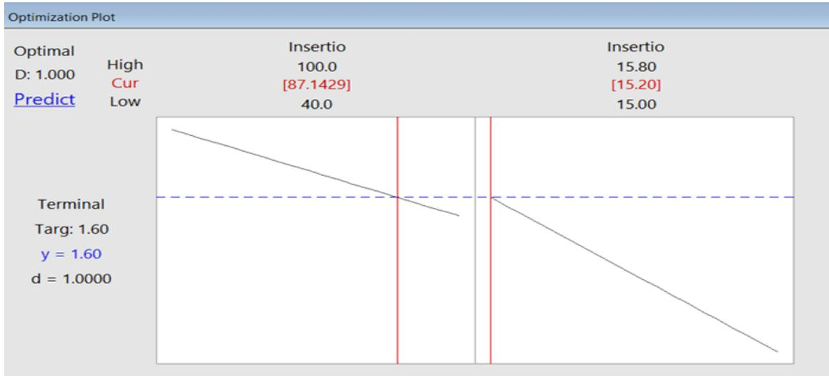
Figura 41. Grafica de Optimización de parámetros Velocidad/Distancia de inserción sobre Altura de terminal
