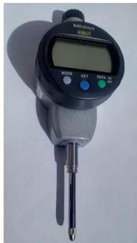
Figura 21. Indicador de Altura Mitutoyo ID-CX
