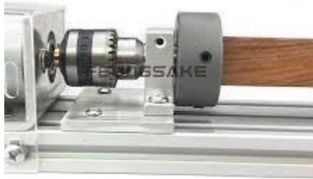
*Figura 12. Mandril utilizado como porta herramienta en el eje contra punto del torno.*
