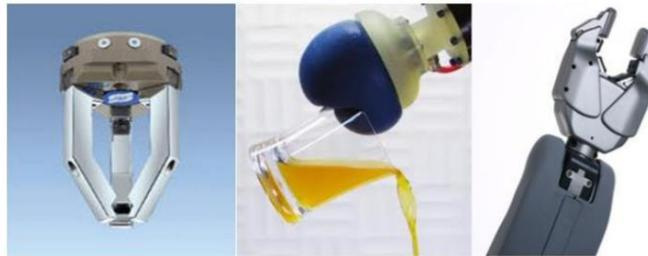
*Figura 17. Diferentes tipos de efectores finales.*
