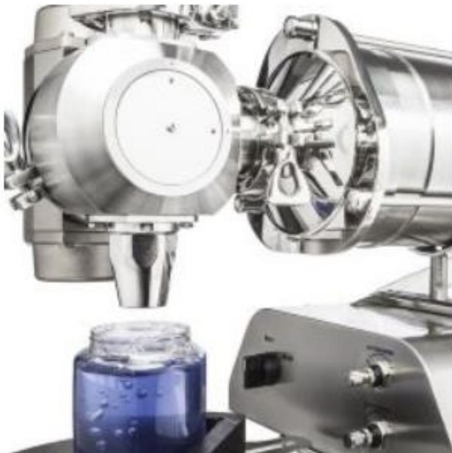
**Figura 6.** Dispensador volumétrico o de tornillo. Fuente: D. Orlando Ortiz, Cristian D. Zambrano, 2017.
