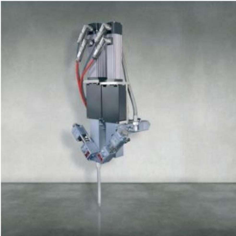
**Figura 7.** Dispensador de pistón. Fuente: D Orlando Ortiz, Cristian D. Zambrano, 2017.
