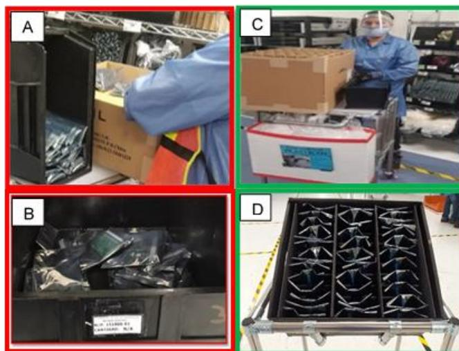
Figura 16: Fixtura para proteger PCBA. Elaboración propia
