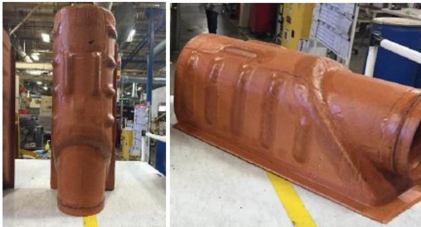
*Figura 19 Plenum fabricado de material compuesto
