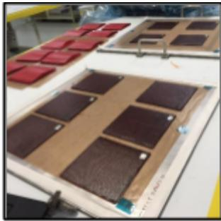
Se crearon 10 paneles con diferentes configuraciones de capas y mismo proceso de curado.
