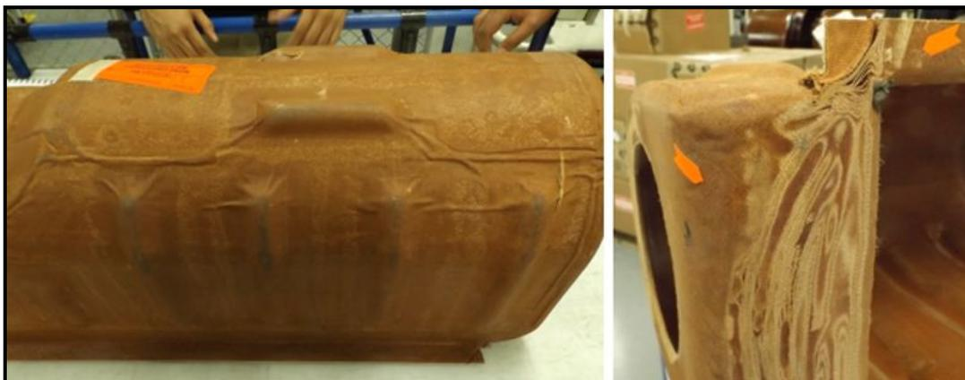
*Figura 12 Defectos en Diseño actual Plenum GV.
