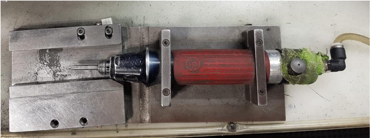
Figura 12 - Desarmador neumático con Fixtura para el ajuste mecánico. Fuente: elaboración propia.
