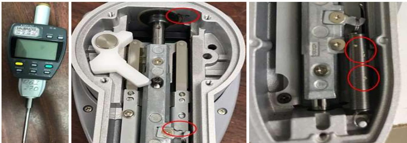
Figura 6. Daños mecánicos en equipos longitudinales. Fuente. Elaboración Propia
