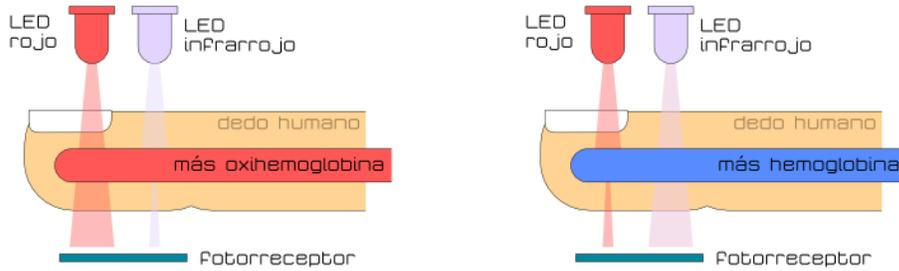
**Figura 2.** Representación del funcionamiento de un oxisensor. **Fuente:** Meza Contreras L., Llamosa R. L. E., Ceballos, S. P., 2007
