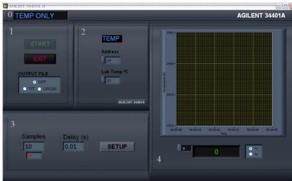
Figura 3. Panel frontal de la aplicación con Multímetro Agilent 34401.
