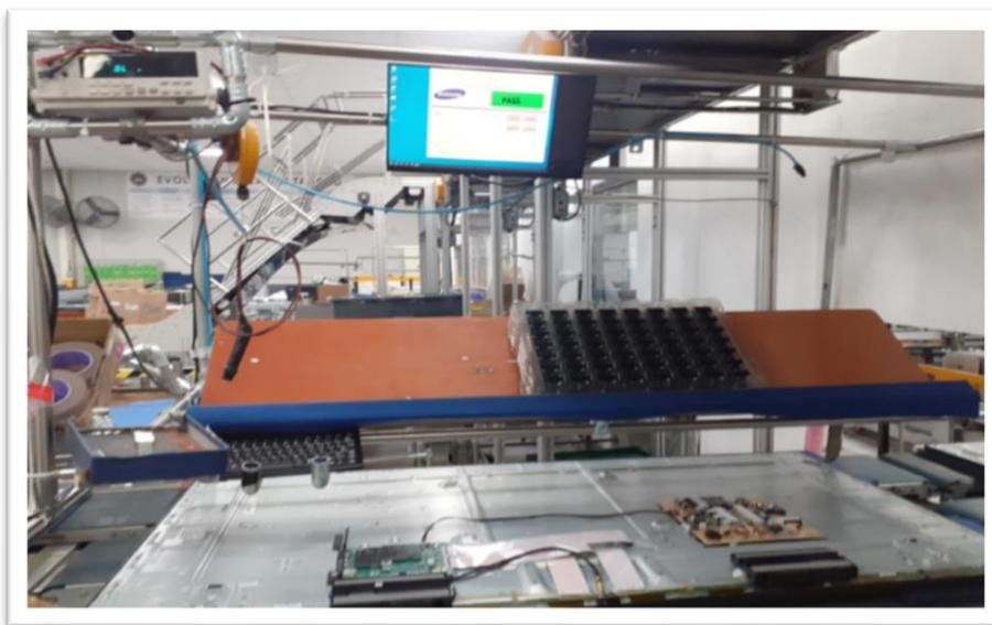
**Figura 37.** Sistema de detección de fallas en funcionamiento en la línea de producción M42.
