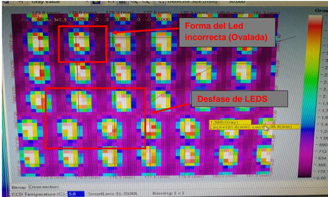
*Ilustración 26. Vista del LED mal enfocado y con desfase*
