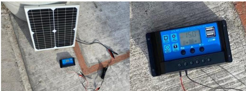
Figura 28 Celda fotovoltaica en operación conectada a regulador (izquierda) y acercamiento al regulador operando (derecha).
