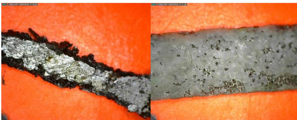
Figura 43 Imagen tomada con microscopio para visualizar la calidad resultante de los electrodos en la muestra de Misión, acero (izquierda) y Ni-espuma (derecha).
