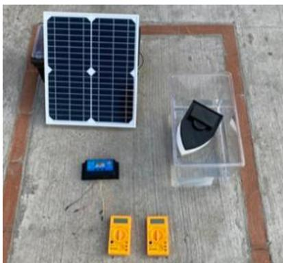
Figura 31 Componentes de la celda foto-electrolítica.
