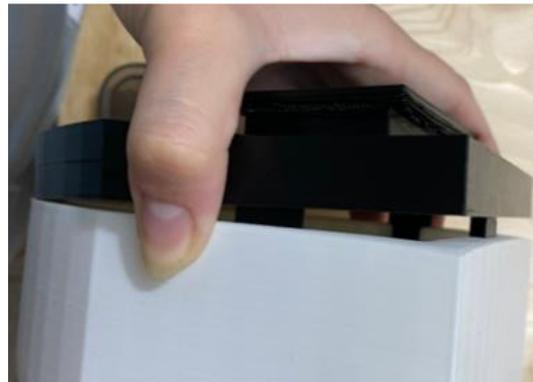
Figura 23 Modo de ensamble de barco. Consiste en conectar los espacios de inserción entre ambas partes con las barras de ensamble.
