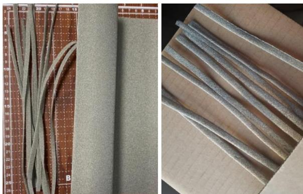
Figura 27.1 Níquel espuma cortado del rollo con medidas de 1.5 x 5 x 25 mm, aproximadamente debido a consistencia del material (izquierda). 27.2 Electrodo con variación en la coloración posterior al tratamiento de níquel electrolítico (derecha).
