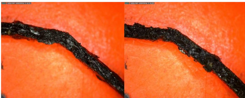
*Figura 45 Vistas laterales de los efectos de corrosión en los electrodos de la muestra de Misión.*
