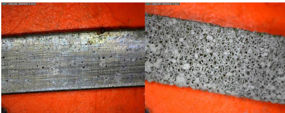
Figura 41 Imagen tomada con microscopio para visualizar la calidad resultante de los electrodos en la muestra de Bahía, acero (izquierda) y Ni-espuma (derecha).
