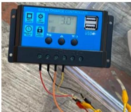
Figura 29 Regulador de celda fotovoltaica con caída de voltaje al ser conectado a los electrodos. Estos comienzan a operar con un voltaje de 3V.
