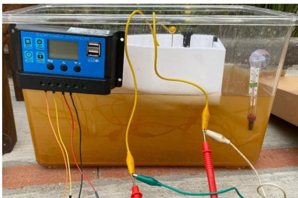
Figura 38 Agua residual tras el proceso de electrólisis con la muestra de Bahía.
