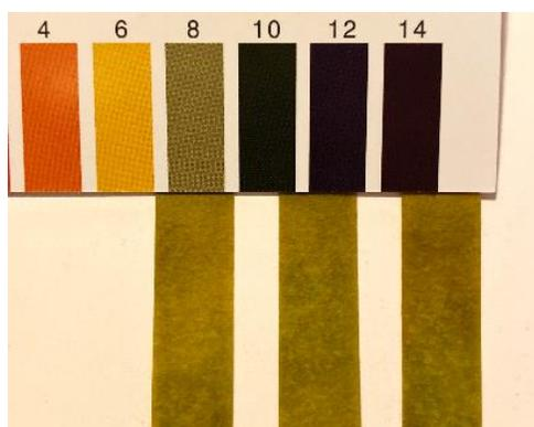
Figura 34 Muestras de pH con papel de prueba comparado contra patrón estándar. Las muestras se encuentran consistentes.
