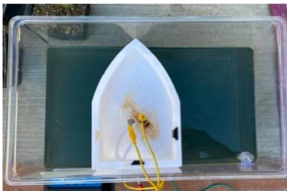
Figura 40 Agua residual tras el proceso de electrólisis con la muestra de Misión.
