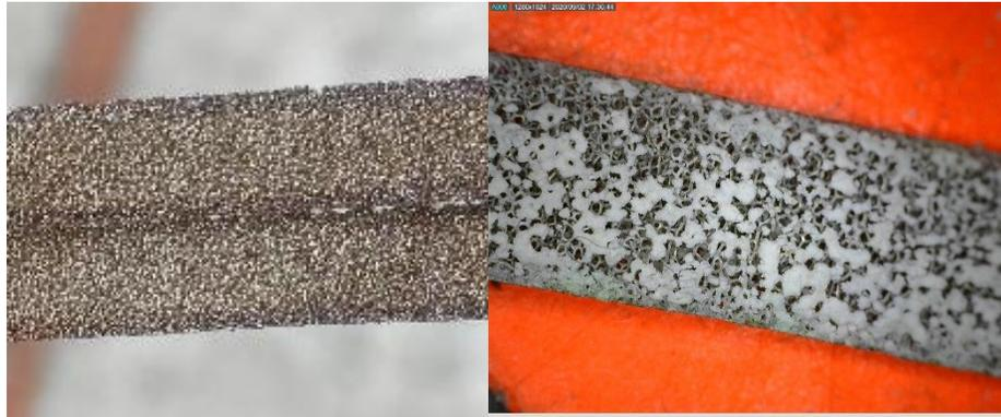
*Figura 46 Comparación del cátodo previo y post el proceso de electrólisis.*
