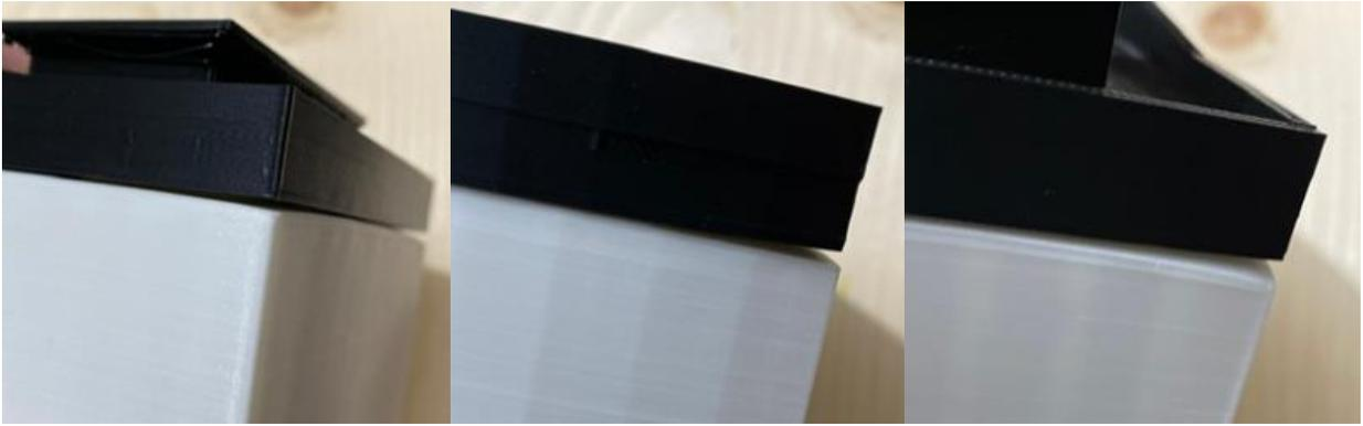
*Figura 24 Defectos de deformación en las esquinas de la base y parte superior del barco. Se muestran las tres esquinas del mismo mostrando la deformación.*
