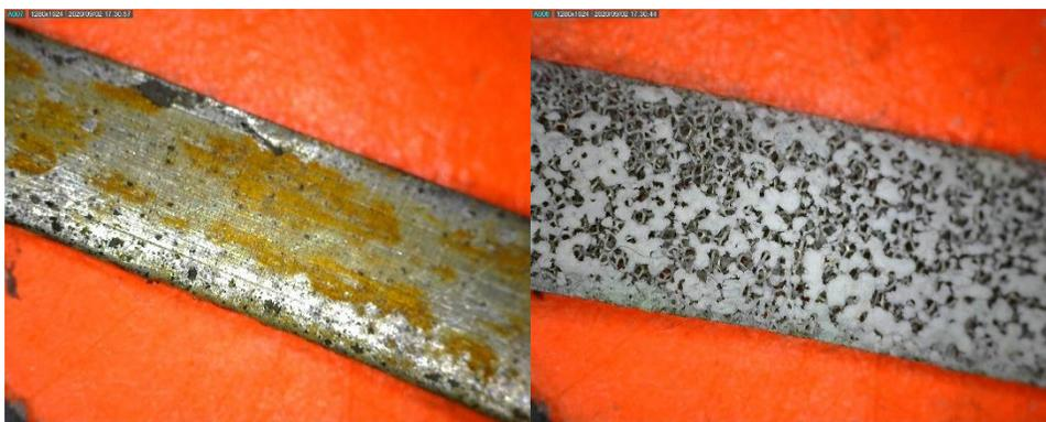
Figura 42 Imagen tomada con microscopio para visualizar la calidad resultante de los electrodos en la muestra de Valle, acero (izquierda) y Ni-espuma (derecha).
