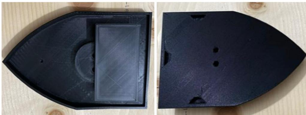
*Figura 18 Vistas superior (izquierda) e inferior (derecha) de la parte superior del barco.*
