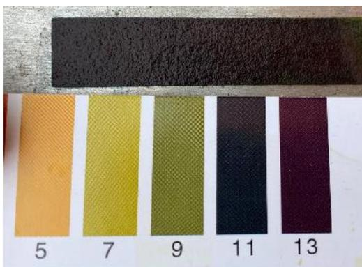
Figura 44 Prueba de pH en agua residual.
