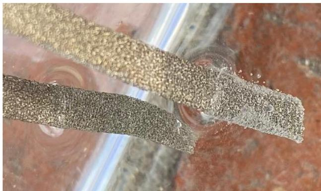
Figura 30 Electrodo en proceso de electrólisis a un voltaje de 3V.
