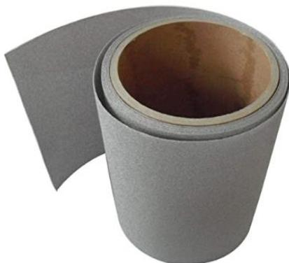
Figura 8 Electrodo. 8.1 Materia prima para manufactura de electrodos a base de espuma níquel (izquierda). 8.2 Electrodo a base de espuma níquel, recubiertos de níquel electrolítico y níquel-zinc (medio); 8.3 Electrodo de acero 316SL electrolítico.
