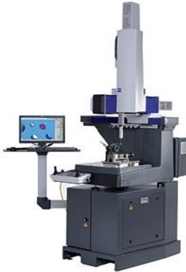
Figura 5.- Máquina por coordenadas CMM Zeiss Fuente: Adaptación. (Zeiss, 2019)
