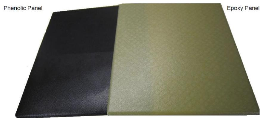
**Figura 2. Panel Material Compuesto con Resina Epóxica**
