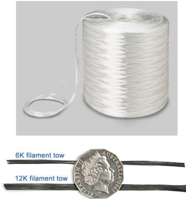
Figura 4. Fibra de Vidrio (Mecha) y Carbono (Cable Filamento)
