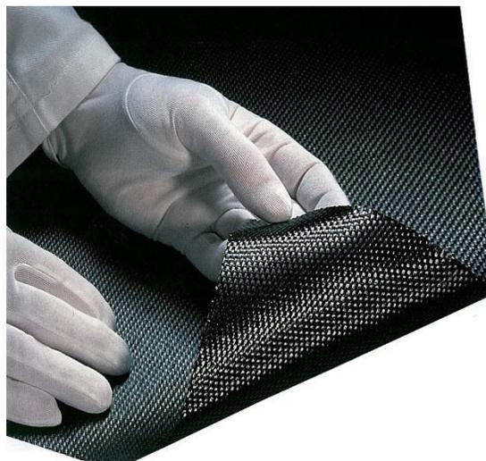
**Figura 6. Prepreg – Epoxi + Vidrio Ejemplo**
