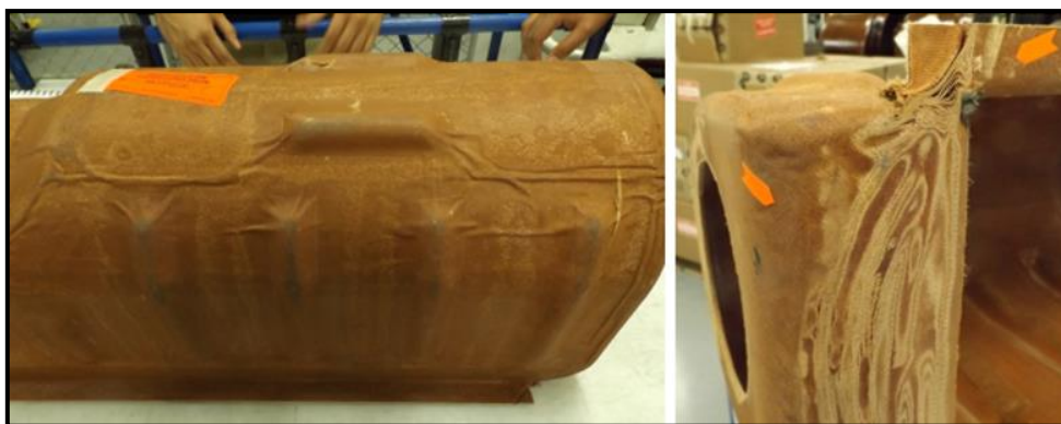
Figura 12 – Defectos en diseño actual Plenum Gulfstream V. Fuente: obtenido de documentación Honeywell.
