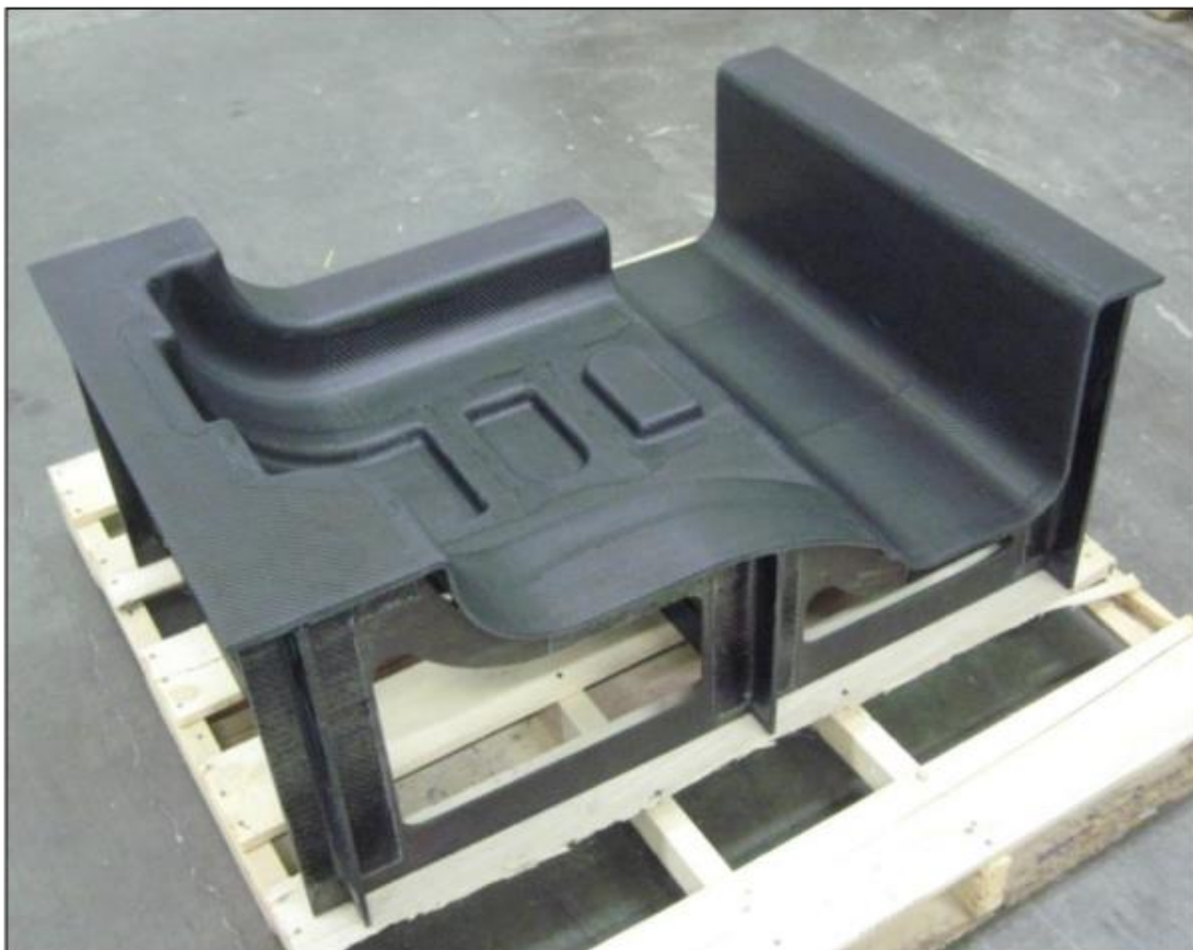
Figura 21. Herramental hecho 100% de BMI utilizado en 50 ciclos a 221C (430F).(Documentacion Honeywell).
