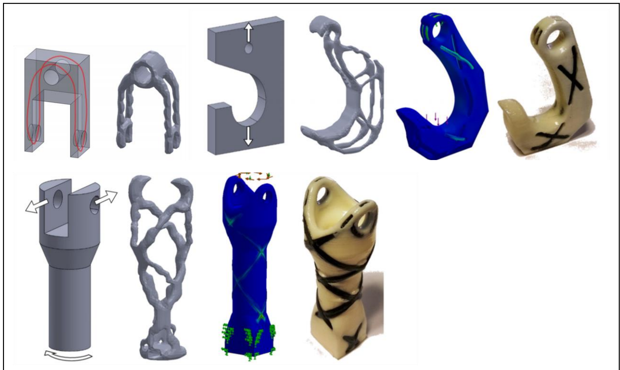
Figura 36. Proceso de optimización topológica para generar componentes de material compuesto, Fuente: Brooks y Molony (2016).
