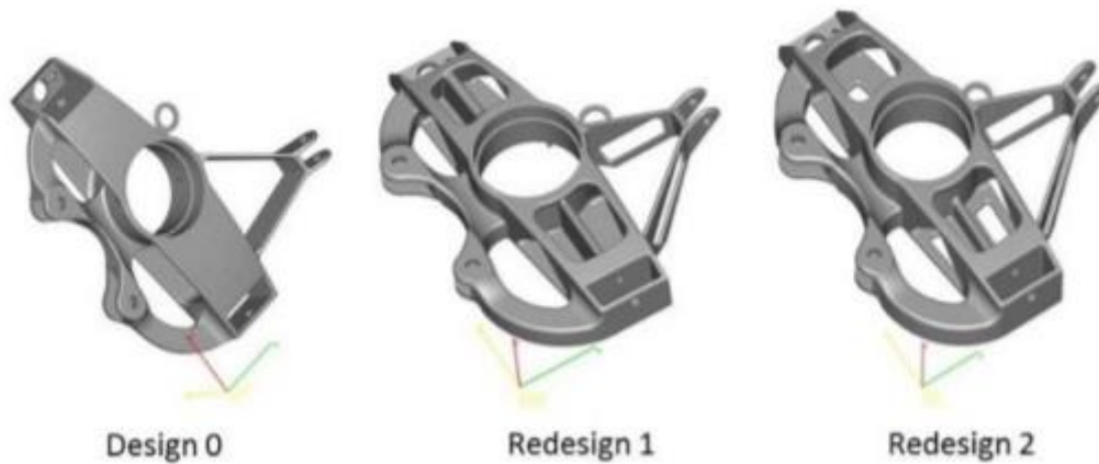
Figura 35. Iteraciones de diseño en función de reducir el material de soporte. Fuente: Reddy et al. (2016).
