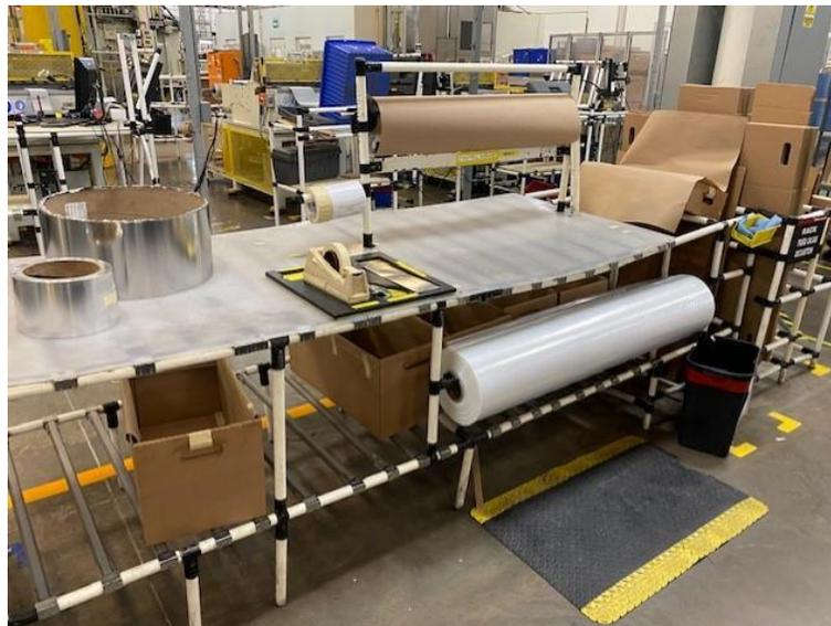
*Figura 5. Mesa de trabajo para acomodo de fins en cajas o bins.*
