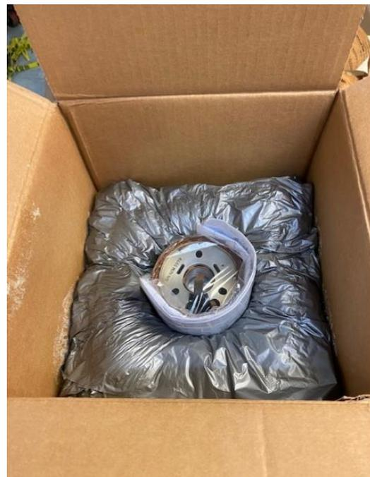
*Figuras 21. Pieza protegida con Instapak Foam en la caja para transporte.*
