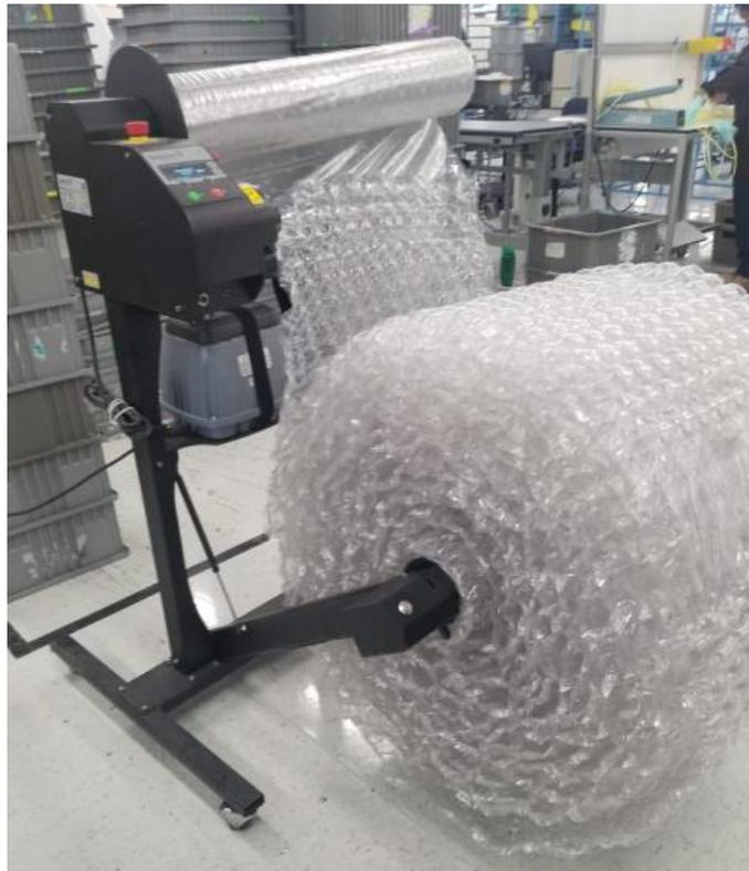
*Figuras 18. Maquina configuradora marca Sealed Air con rollo de burbuja.*
