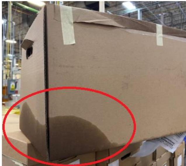
*Figura 10. Ejemplo de caja húmeda a causa del aceite lubricante de fins.
