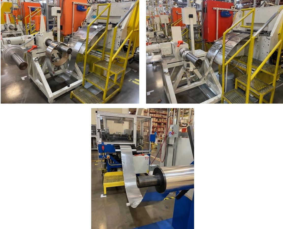
*Figuras 3. Máquinas de conversión de fins con rollos de aluminio.*
