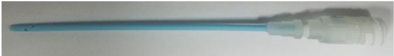
Ilustración 23: Ensamble de componentes impresos 3D con válvula y lumen (elaboración propia).
