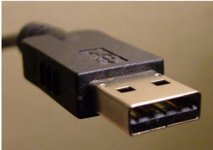
*Figura 2.2 Conector USB, solo permite conectar de una forma*
