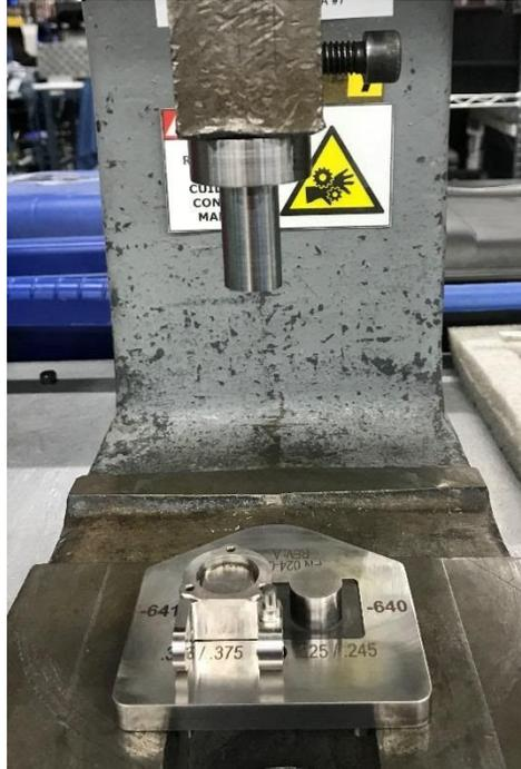
*Figure 15 Proceso de inserción de pin -641. Elaboración propia.*
