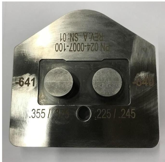
*Figura 4.1 Base para instalación de pines. Elaboración propia.*
