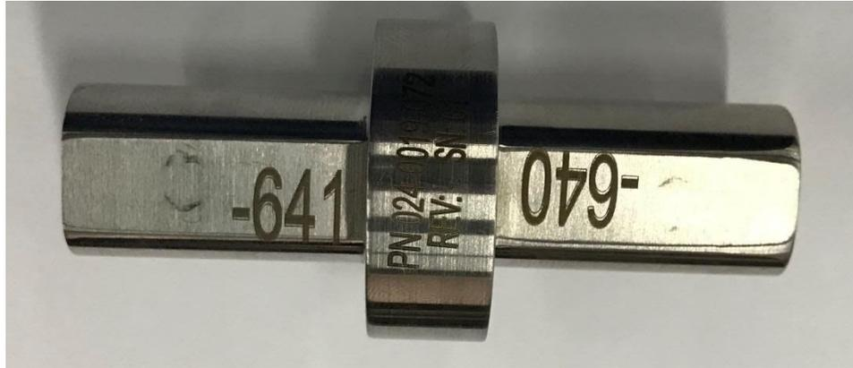
Figure 12 Dado para la instalación a la medida correcta. Elaboración propia.
