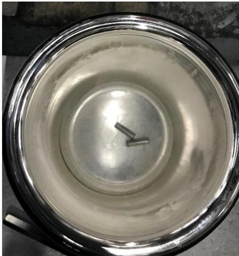
*Figure 14 Proceso criogénico para el ajuste por expansión. Elaboración propia.*
