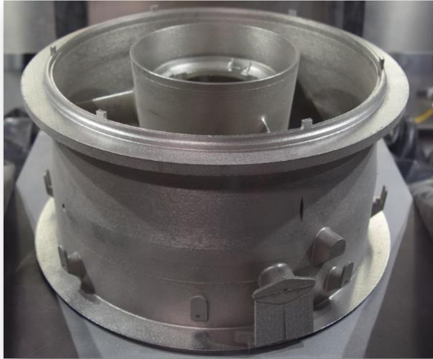
Figura 50. Turbine Bearing Support and Exhaust previo al post procesamiento. Fuente: Elaboración propia.
