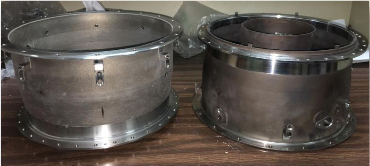
Figura 54. Vistas laterales del Turbine Bearing Support and Exhaust Additive después del maquinado Fuente: Elaboración propia.
