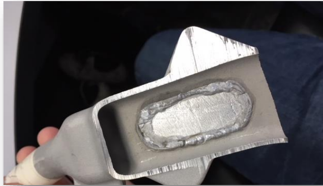
Figura 11. Cordón de soldadura que causa falla en flujo. Fuente: Elaboración propia.
