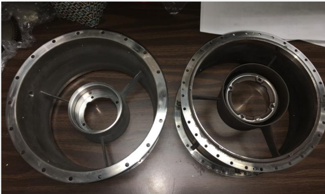
Figura 53. Vista superior e inferior del Turbine Bearing Support and Exhaust Additive después del maquinado. Fuente: elaboración propia.
