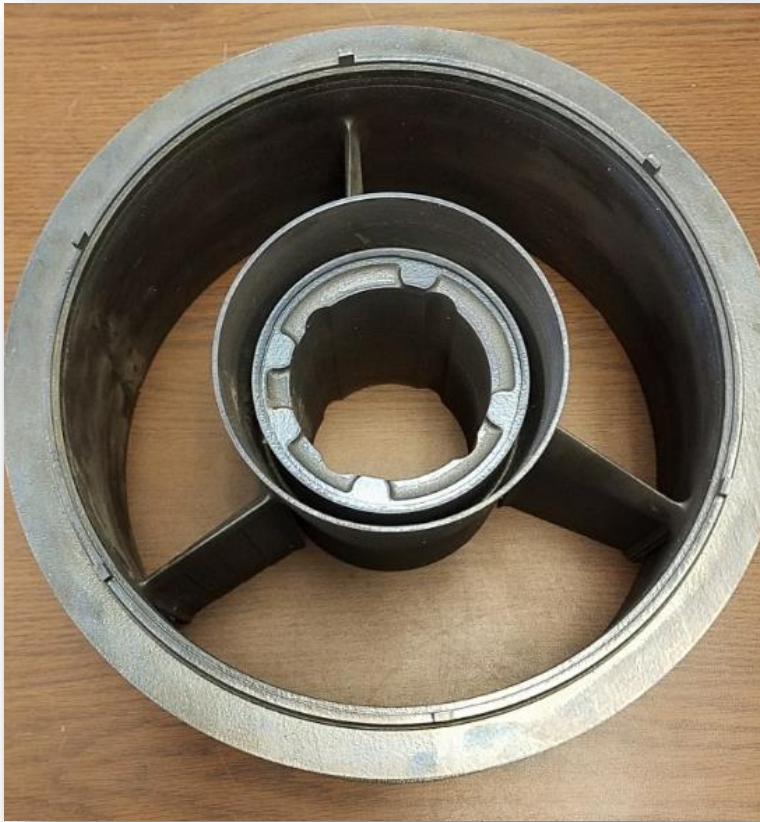
Figura 51. Turbine Bearing Support and Exhaust Additive previo al post procesamiento. Fuente: Elaboración propia.
