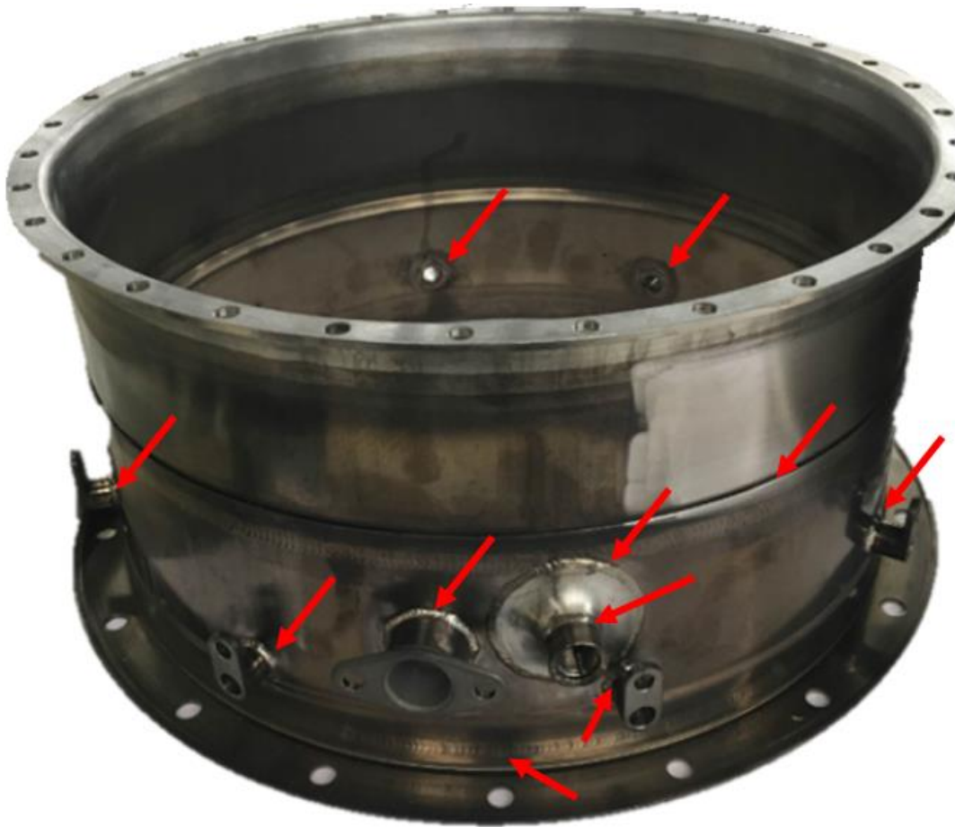
Anexo 2. Exhaust Nozzle original. Costuras de soldadura indicadas con flechas. Fuente: Elaboración propia.
