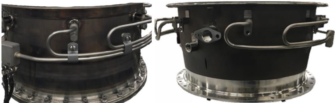
Figura 57. Comparación entre Exhaust Nozzle original (Izquierda) y el nuevo componente (derecha) con conexiones instaladas. Fuente: Elaboración propia.
