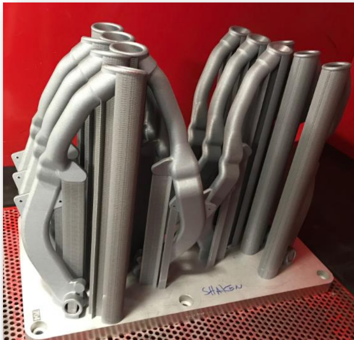
Figura 12. Impresión simultánea de 12 tubos de una sola pieza. Fuente: Elaboración propia.
