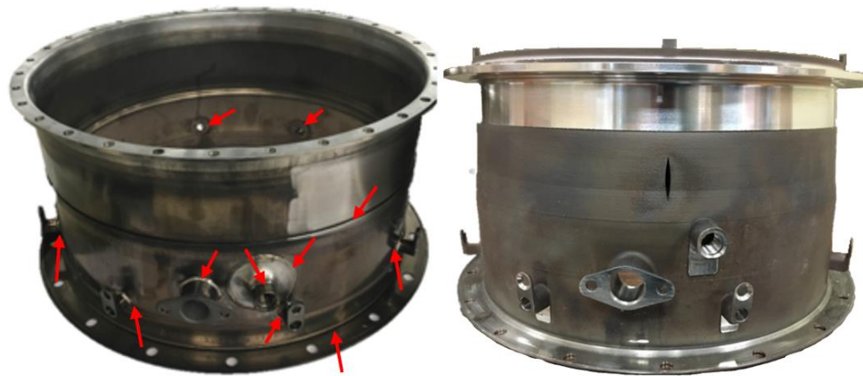
Figura 56. Comparación entre Exhaust Nozzle original (Izquierda) y el nuevo componente (derecha). Fuente: Elaboración propia.
