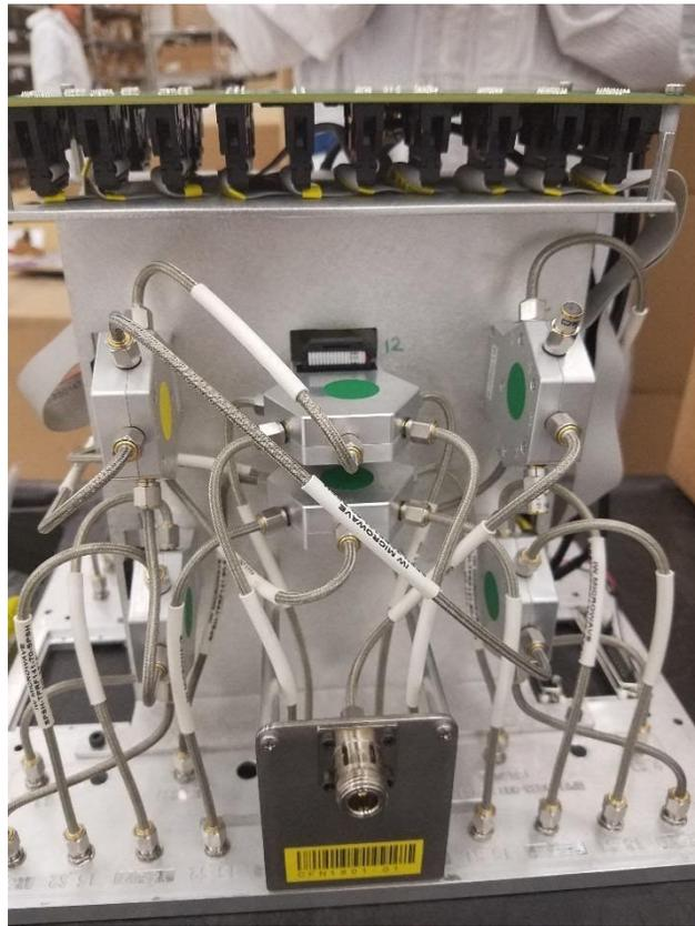
Figura 24. Tablero de calibración automático armado y listo para probar.
