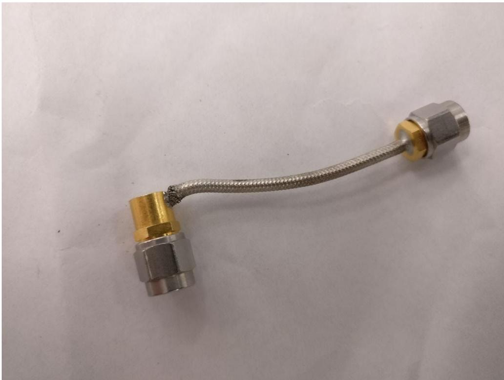
*Figura 21. Cable de RF para Power Sensor dañado, ruptura del recubrimiento metálico.*
