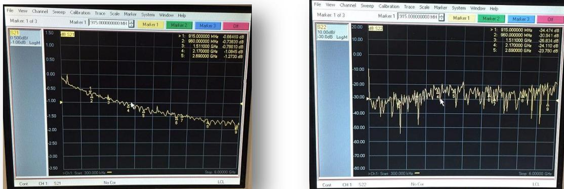
Figura 4.6 Parámetros  $S_{21}$  y  $S_{22}$  del cable p1dB
