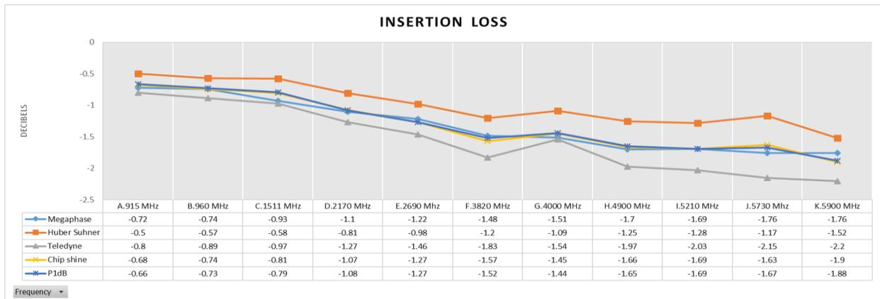
Figura 4.8 Comparación de parámetro  $S_{21}$  entre los 5 tipos de cable
