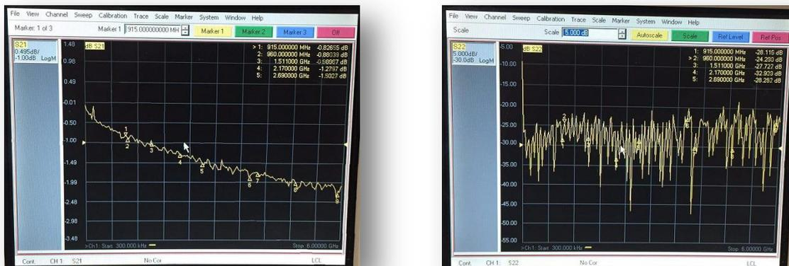
Figure 4.7 Parámetros  $S_{21}$  y  $S_{22}$  del cable Teledyne
