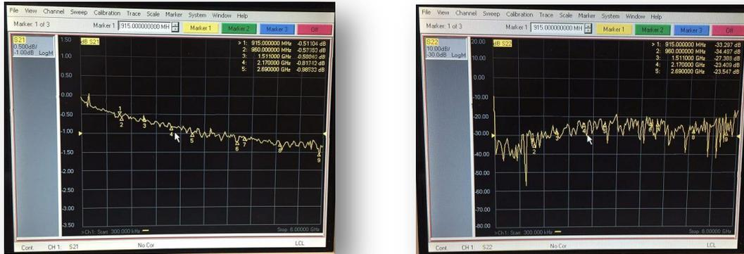
Figura 4.4 Parámetros  $S_{21}$  y  $S_{22}$  del cable Huber Suhner
