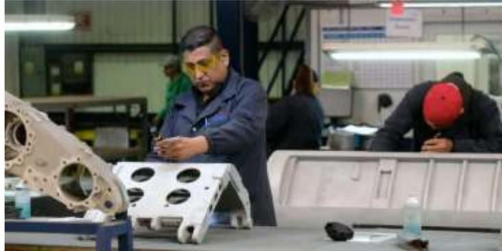
**Figura 1 Inspector evaluando visualmente una bisagra de puerta principal de avión.**
