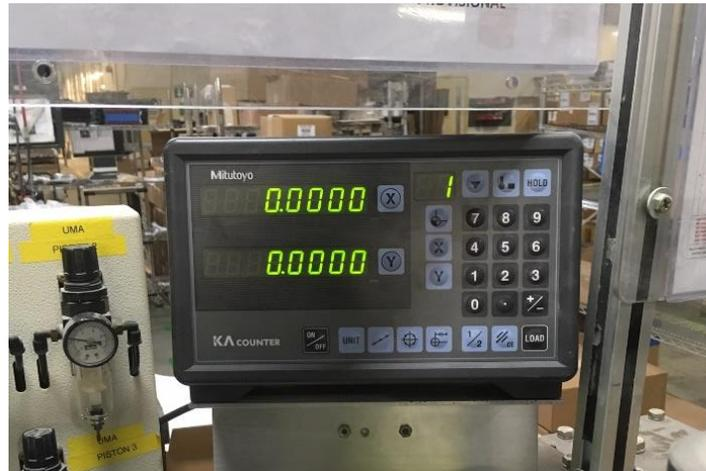
**Figura 21.** Fotografía donde ilustra un sistema de lectura lineal digital, incorporado a la maquina semiautomatizada.
