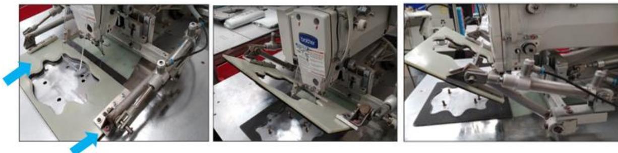
**Figura 14.** Plantillas de sujeción estándar T-342 B, las flechas en azul muestran la ubicación de los opresores (Elaboración propia).
