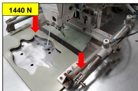
Figura 40. Plantilla de sujeción tipo T-342 B es sujeta a una fuerza de 1440 N. Elaboración propia
