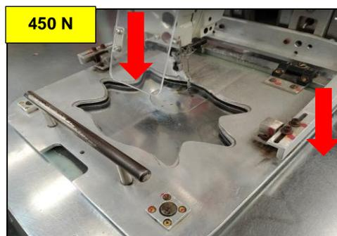
Figura 35. Plantilla de sujeción tipo T-342 A es sujeta a una fuerza de 450 N Elaboración propia
