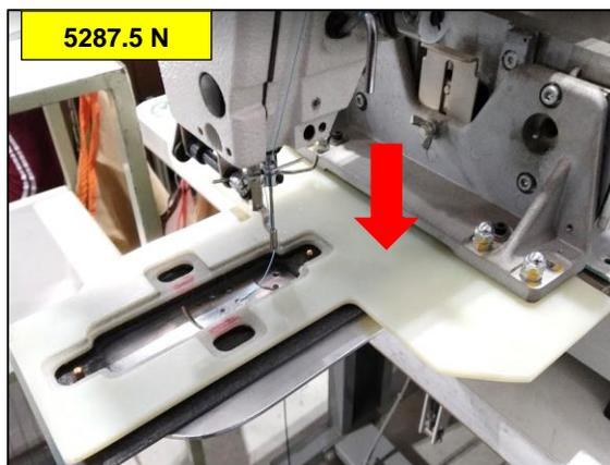
**Figura 30. Plantilla de sujeción tipo T-342 es sujeta a una fuerza de 5287.5 N Elaboración propia**
